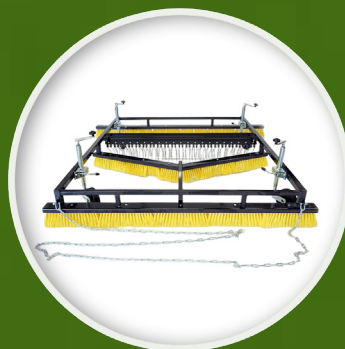
Hooldushari või pehmete teraspiidega hooldushari Iganädalase harjamise seade, mis aitab lahtist täitematerjali laiali jaotada ja väljaku täitematerjali kihti kergelt kobestada.
