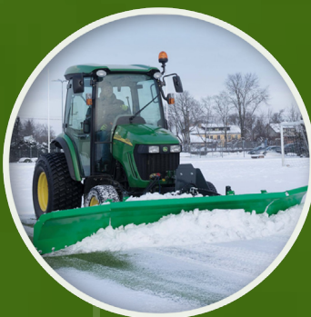
Muruhooldustraktor + sahk mururehvidega traktor koos sahaga lume koristamiseks (lükkamiseks) väljakult.
